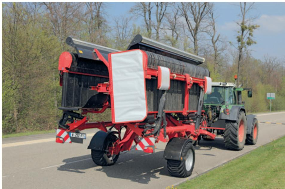
Благодаря таким особенностям, как меньшая длина машины, оптимизированная функция складывания, система сцепки с амортизаторами (эксклюзивная и запатентованная технология на моделях MM 950 и MM 1090) и сдвинутый еще больше назад шарнирный узел, эти ленточные валкообразователи имеют очень небольшие габариты, устойчивы на плохих дорогах, а также легко разворачиваются на поворотной полосе.
