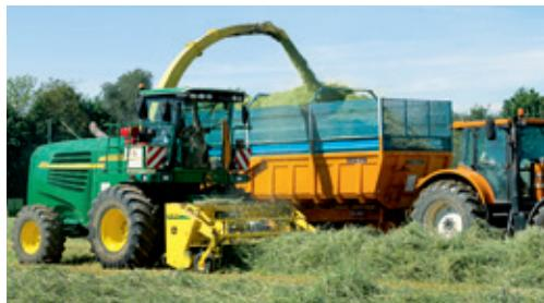
Ваша кормоуборочная техника сможет работать с более высокой скоростью, если сформирован равномерный валок. При постоянной скорости движения механизатор не подвергается стрессу, связанному с:
