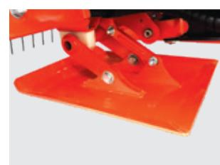
**Шарнирно-сочлененные рамы.** Четыре большие шарнирно-сочлененные рамы регулируются по высоте, благодаря чему отлично повторяют рельеф поверхности и точно направляют все узлы подборщика. Централизованная регулировка высоты рамы с помощью кривошипной рукоятки обеспечивает дополнительный комфорт при работе на машинах моделей MM 950 и 1090.
