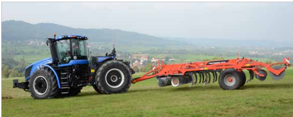
Performer: универсальность этого орудия впечатляет. Можно работать зубьями и дисками, а можно лишь зубьями или только дисками.
